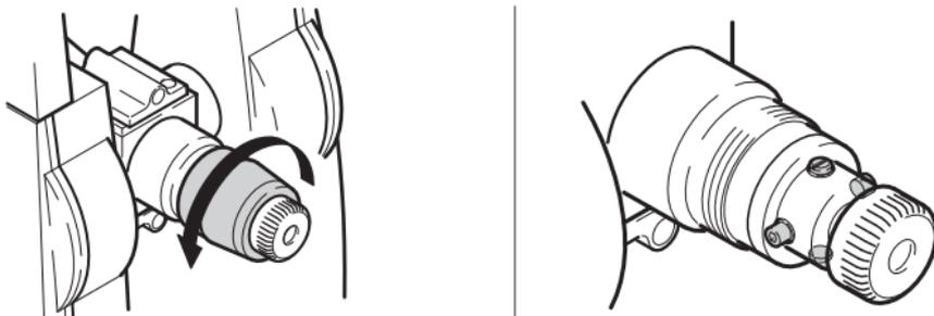
1. Bewegt sich der Punkt nicht entlang des vertikalen Fadens, entfernen Sie die Abdeckung der Justierschrauben auf dem Okular.
