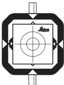
1. Stellen Sie das beigelegte Flachprisma CPR105 in ca. 5 m bis 20 m Entfernung vom Instrument auf und richten Sie die Seite mit der Reflexfolie zum Instrument aus.
