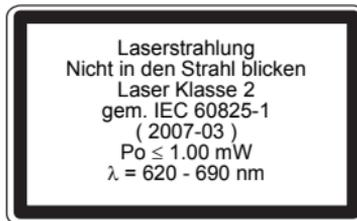
a) Wird ersetzt durch Klasse 3R Laserwarnschild, wenn zutreffend
