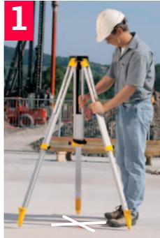
Stativfüsse ausziehen, bis eine angenehme Arbeitshöhe erreicht ist. Stativ über dem markierten Bodenpunkt aufstellen und so gut wie möglich zentrieren.
