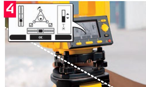
Horizontieren Sie die elektronische Libelle für die zweite Achse durch Drehen der dritten Fußschraube. Die Drehrichtung der Fußschraube wird durch Pfeile angezeigt.
