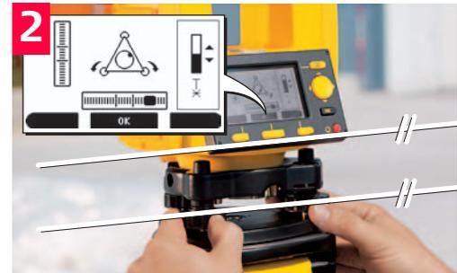
Elektronische Libelle dieser Achse durch Drehen der beiden Fußschrauben horizontalisieren. Die Drehrichtung der Fußschrauben wird durch Pfeile angezeigt.
