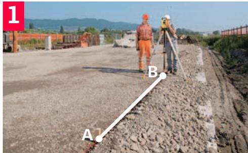
Stellen Sie das Instrument über Punkt B auf und horizontieren Sie es.
