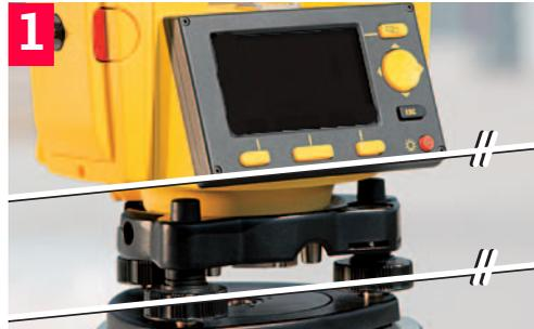
Instrument durch Drücken der entsprechenden Taste einschalten.
